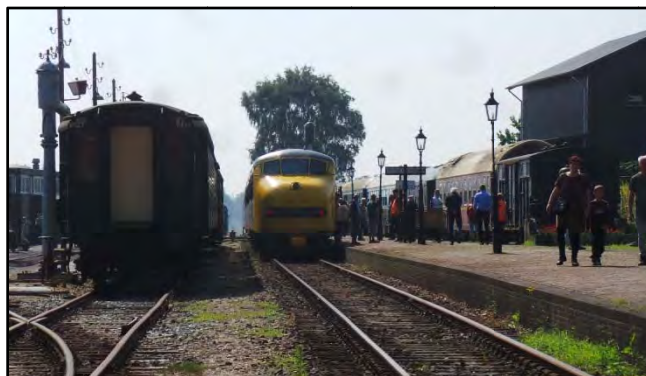
De kenmerkende neus was bedoeld om de machinist bij aanrijdingen een betere bescherming te bieden dan bij het oudere stroomlijnmaterieel het geval was. Tussen 1956 en 1962 zijn in totaal 73 vierwagengestellen en 68 tweewagengestellen geleverd.
